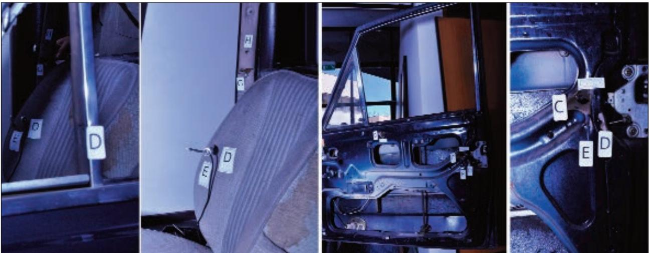
Fig. 12 - Fiat 130 - impatti denominati "D" rilevati tramite replicatore laser
