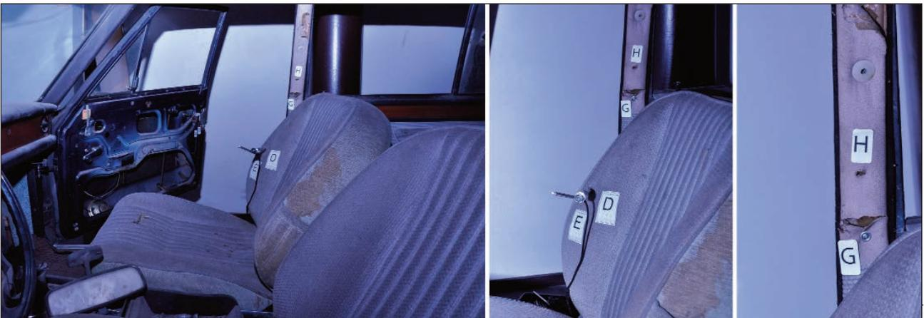
Fig.15 - Fiat 130 - impatti denominati "G - H" rilevati sul montante destro
