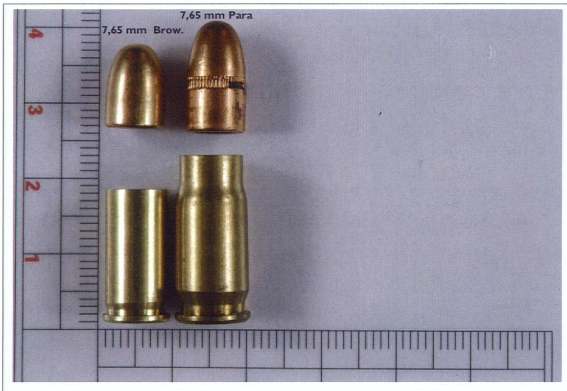
Foto nr. 21: esempio di cartucce 7,65 mm Parabellum e 7,65 mm Browning disassemblate a confronto
