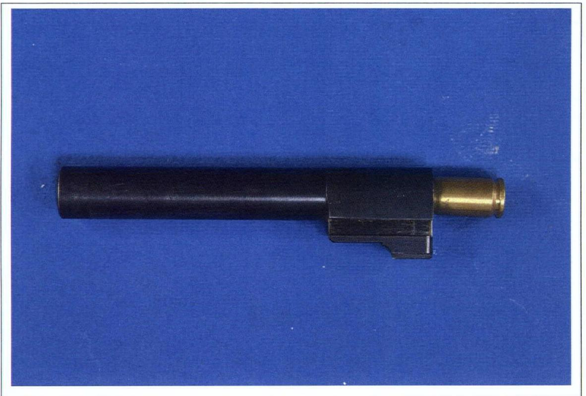
*Foto nr. 26: particolare di una cartuccia cal.7,65 mm Parabellum inserita nella camera di cartuccia della pistola Beretta 70 (REP000040894), vista di lato*
