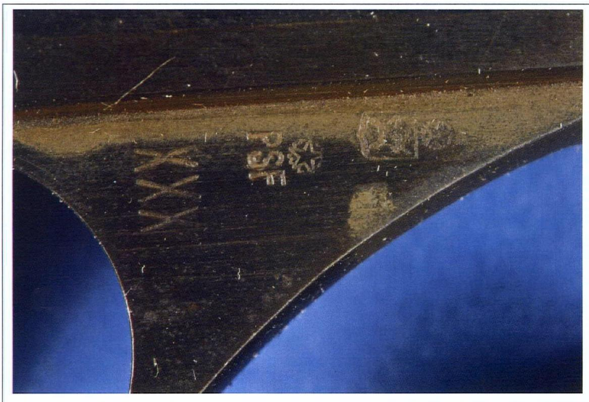
Foto nr. 15: particolare dei punzoni impressi sul lato destro del ponticello
